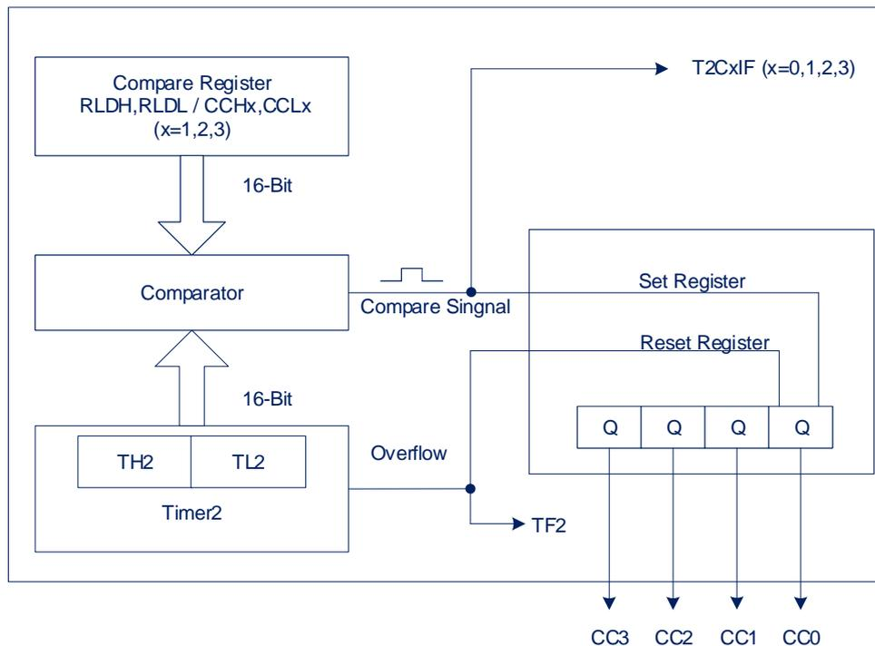
比较模式 0 的输出结构框图如下图所示：
