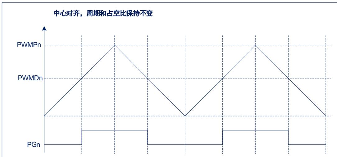
中心对齐对称计数，占空比改变的时序图如下图所示：
