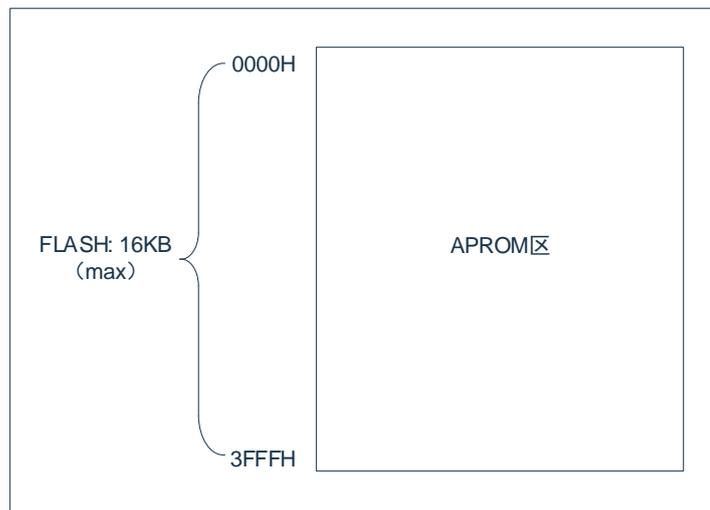
芯片复位后，CPU 从 0000H 开始执行。每个中断在程序存储器中都分配有固定的地址，中断使 CPU 跳到该地址开始执行服务程序。
