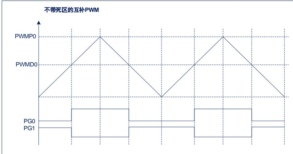
在电机控制应用当中，理想的 PWM 信号是在同一时刻发生电平的翻转，由于 MOS 管的开通和关断存在着延时，这样就容易造成电源对地直通，从而损坏功率管。为了避免这种现象，带死区时间的 PWM 就显得尤为重要。在互补模式下，每组互补 PWM 均支持插入死区时间，插入的死区时间如下：
