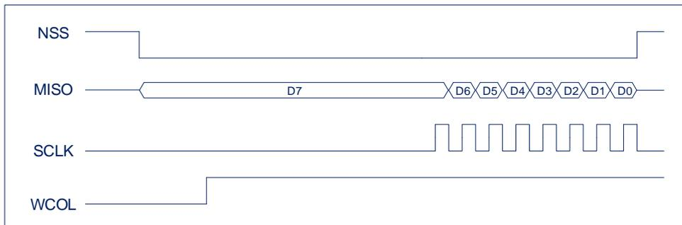
另外，从动模式下在写 SPDR 之后，主机控制的 NSS 并不是立即变为低电平。当 NSS 为低后，需要等待 SCLK 第二个边沿才开始进入真正的数据传输状态。
