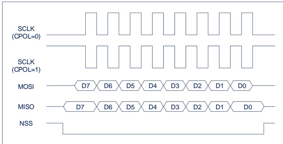
当 CPHA=0 时, NSS 线必须在每个连续的串行字节之间解除置 1 并重新置 1。此外, 如果当 NSS 处于低电平, 从机将数据写入 SPI 数据寄存器 (SPDR), 则会产生写冲突错误。当 CPHA = 1 时, NSS 线可能在连续传输之间保持低电平 (可以始终保持低电平)。在具有单个固定主机和驱动 MISO 数据线的单个从机的系统中, 这种格式有时是优先选择的。
