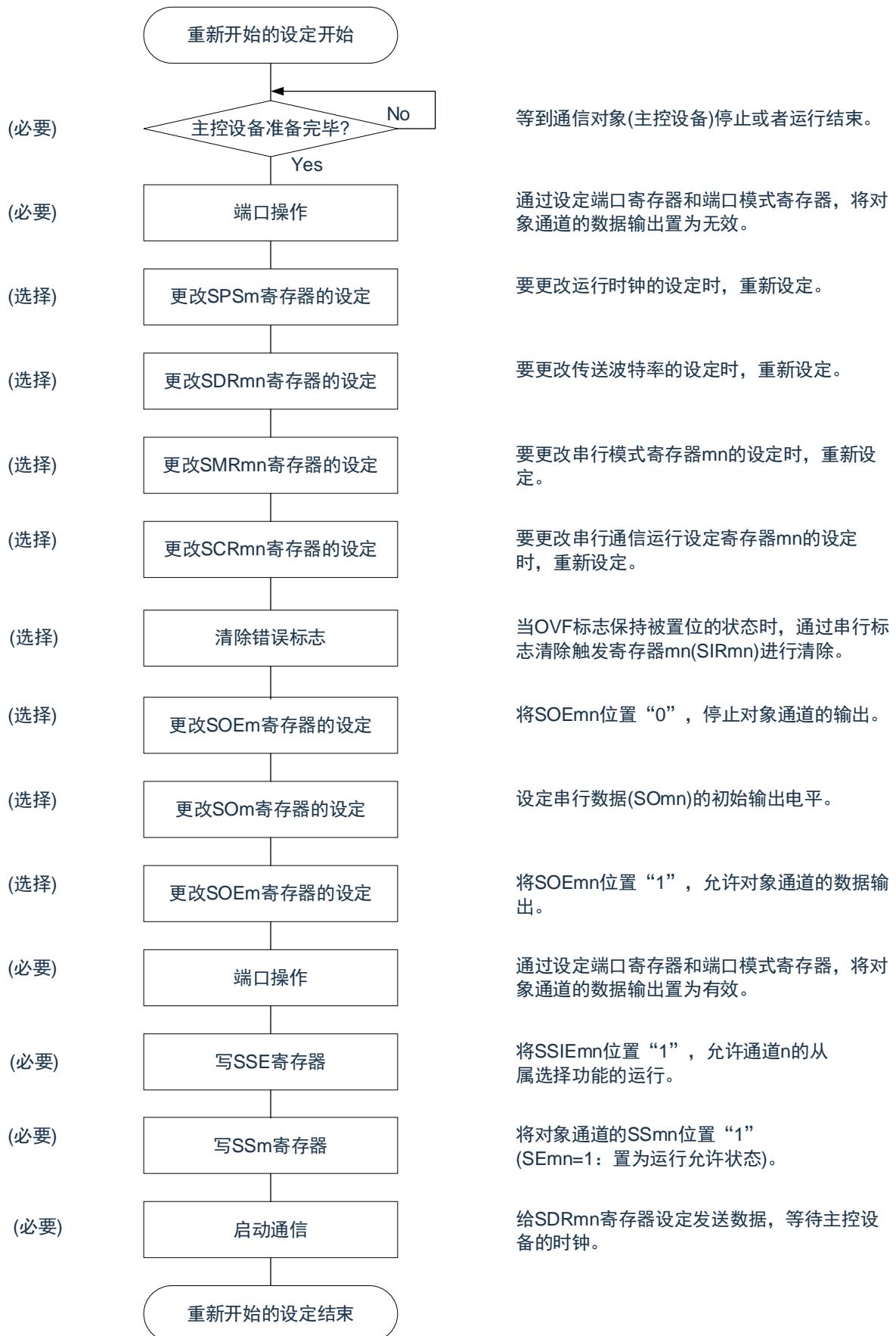
图 16-75: 重新开始从属发送的设定步骤
