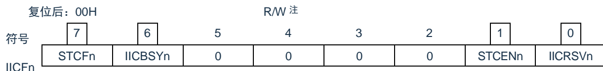
图 18-8: IICA 标志寄存器 n (IICFn) 的格式
