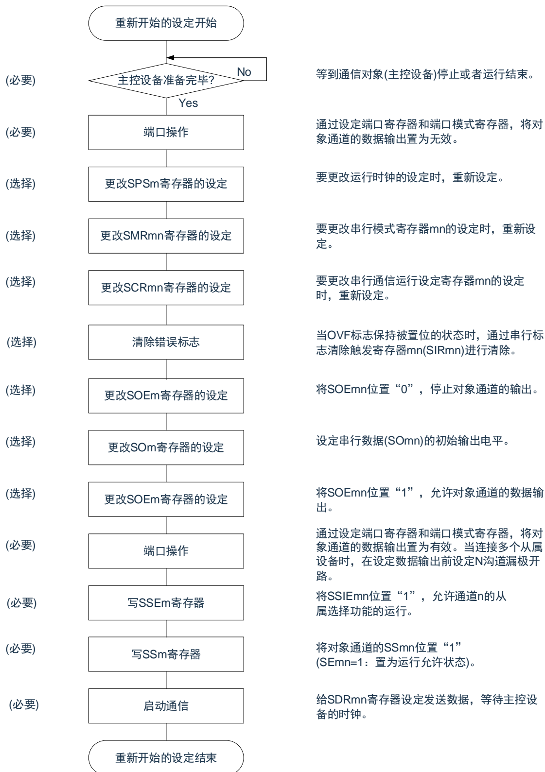
图 16-90: 重新开始从属发送和接收的设定步骤
