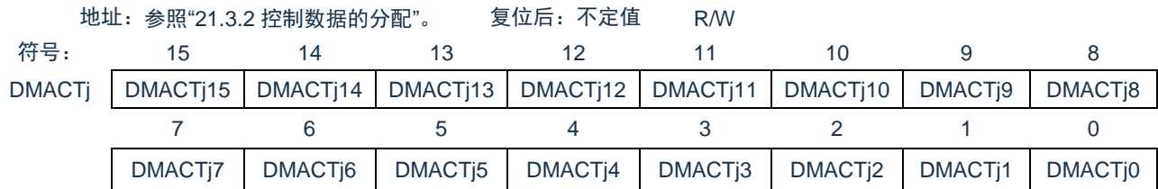
图 21-7: DMA 传送次数寄存器 j (DMACTj) 的格式
