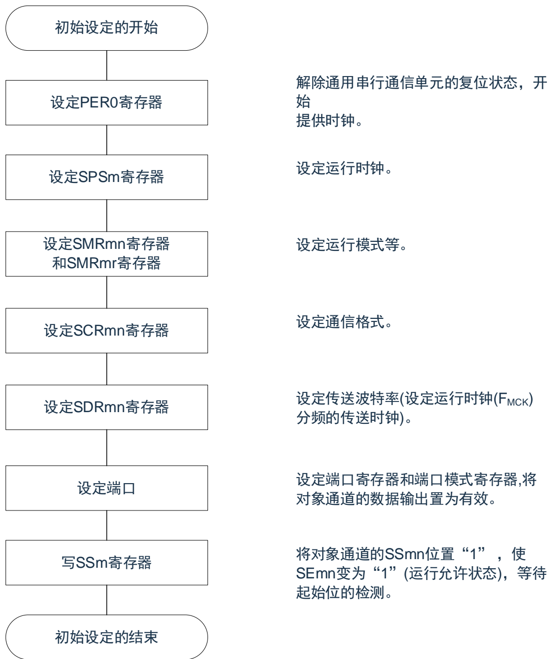
图 16-105: UART 接收的初始设定步骤
