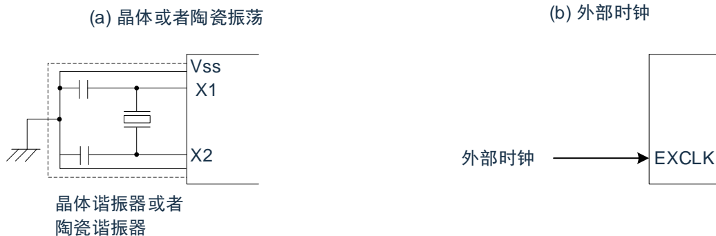
图 4-13：X1 振荡电路的外接电路例子
