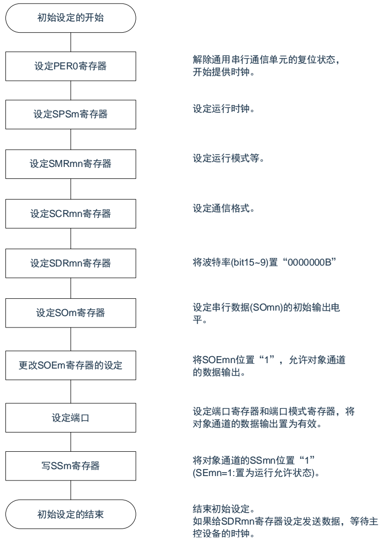
图 16-48: 从属发送的初始设定步骤
