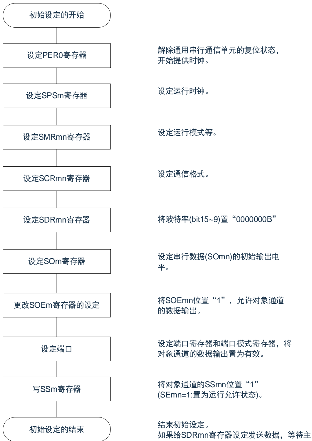
图 16-62：从属发送和接收的初始设定步骤
