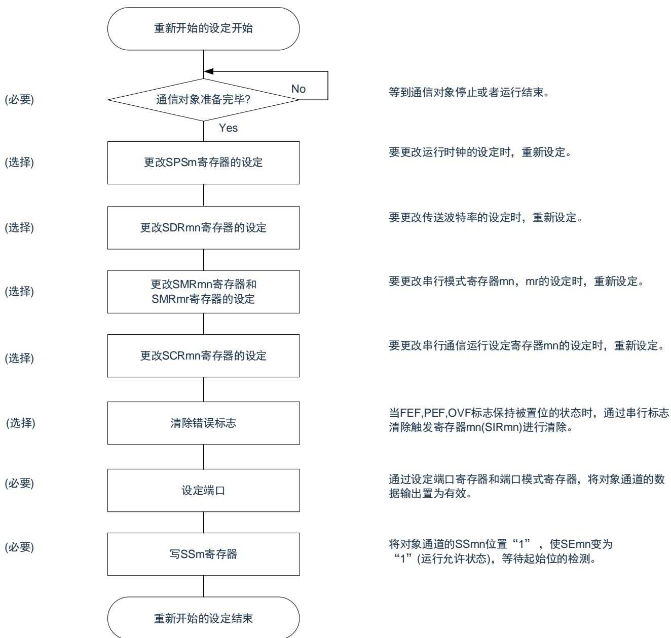
图 16-107: 重新开始 UART 接收的设定步骤
